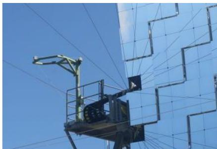
Particolare del telescopio MAGIC, costituito da quasi 1000 specchi di alluminio.
